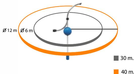
Es un equipo fabricado bajo los más altos estándares de calidad, diseñado para una eficaz y uniforme distribución de alimento. La dispersión de alimento se produce por la rotación de su boquilla giratoria, movimiento generado gracias a la fuerza del aire.
